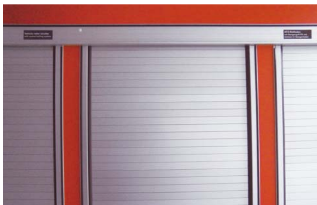
Mit Abdichtung zwischen den einzelnen Panelen
